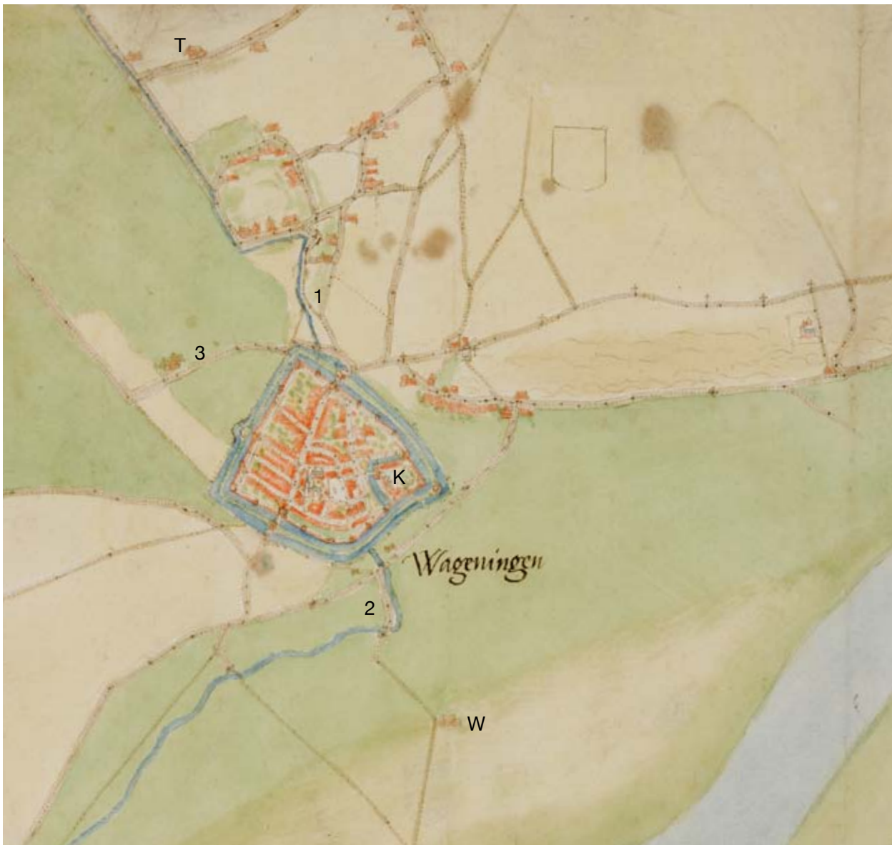
De vesting Wageningen ingeklemd tussen de stuwwal en oeverwal (in de kaart van v Deventer 1562). De Dijkgraaf voert water aan naar de gracht (1) en een oude rivierarm voert het water van de gracht af naar de Rijn (2). De Oldendam (3) met Huize De Lawick beschermt de vesting tegen wateroverlast vanuit de Vallei. Binnen de vesting ligt het kasteel (K) en buiten de vesting liggen de versterkte huizen Tarhorst (T) en Wolfswaard (W).
